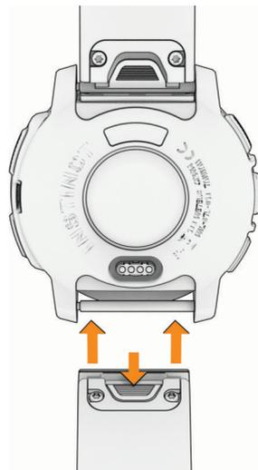
**ПРИМЕЧАНИЕ.** убедитесь, что ремешок закреплен надежно. Фиксатор должен защелкнуться на штырьке часов.
