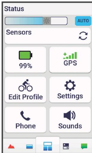
Появится виджет состояния. Мигающий значок указывает на то, что устройство выполняет поиск сигнала. Непрерывно отображающийся значок указывает на то, что сигнал найден или датчик подключен. Для изменения настроек можно выбрать любой значок.
