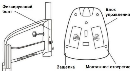
Отвинтите фиксирующую ручку на поисковой катушке и снимите разъем ручки. Поместите уплотнительные шайбы в канавку нижнего штока. Затем вставьте шток и совместите отверстия на кронштейне поисковой катушки и штоке. Протолкните разъем через отверстия и затяните гайку.
