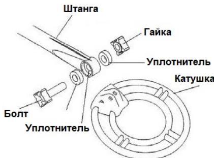
Нажмите серебристую кнопку (фиксатор) на верхнем конце нижнего стержня и вставьте нижний стержень в верхний стержень. Отрегулируйте длину стержня так, чтобы вам было удобно, когда вы стоите вертикально с детектором в руке и поисковой катушкой. находится на уровне земли, а ваша рука расслаблена сбоку. Затем поверните против часовой стрелки, чтобы затянуть стопорную гайку.
