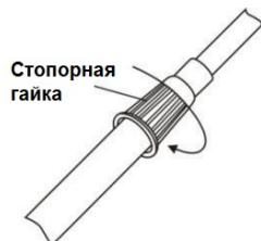
Намотайте кабель поисковой катушки на штангу. Вставьте штекер поисковой катушки в гнездо поисковой катушки на блоке управления детектора.
