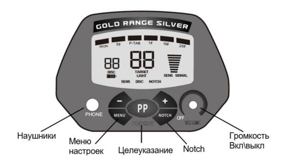
Регулятор ГРОМКОСТИ выполняет функцию включения и отключения устройства. Поверните регулятор громкости в положение ВЫКЛ., чтобы включить детектор.
