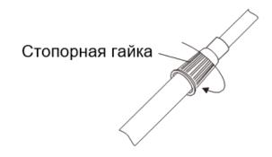
Затем поверните против часовой стрелки, чтобы затянуть стопорную гайку.
